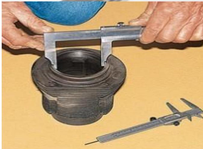
Pour une mesure intérieure (ici largeur d'une rainure), le pied à coulisse au 1/10e est doté de deux becs opposés. Agir sur la coulisse jusqu'au contact des becs avec la rainure.
