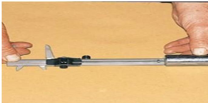
Cette pièce peut être mesurée en profondeur par la jauge solidaire de la coulisse. Le pied de la règle s'appuie sur l'entrée de la pièce, la jauge touche le fond du trou borgne, la lecture se fait sur le vernier.
