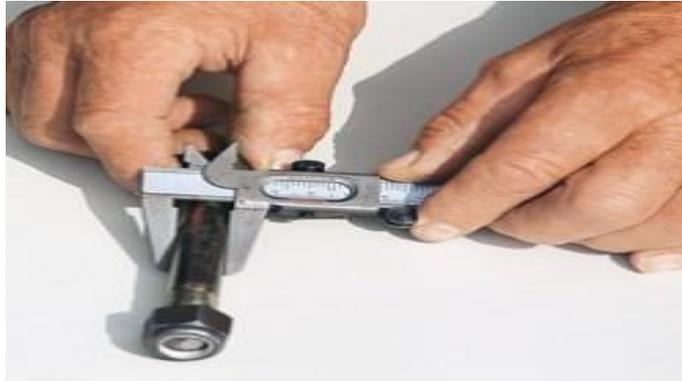
Pour une mesure extérieure, écarter les becs, puis ramener la coulisse pour que ces becs pincent légèrement la pièce à mesurer, uniformément mais sans forcer. Relever la mesure.
